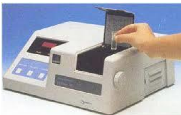
Figure 7 : Schéma d'un spectrophotomètre HACH DR/4000U
