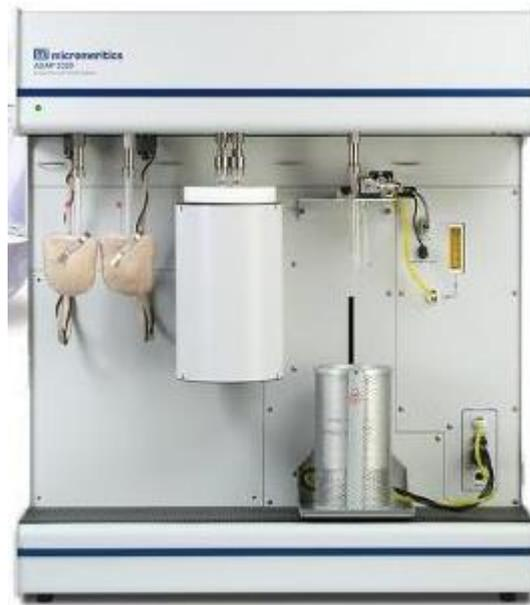
**Figure 8 :** Appareil ASAP 2020 pour l'obtention des isothermes d'adsorption.
