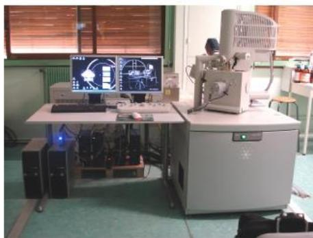
*Figure 7: Microscope électronique à balayage*
