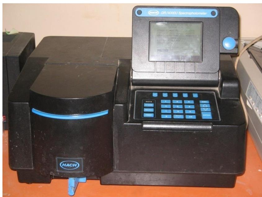
**Figure 2 :** Spectrophotomètre UV-visible (DR/4000 U spectrophotometer HACH)
