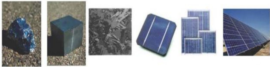
Silicium purifié Lingot Wafer Cellule Module Systèmes
