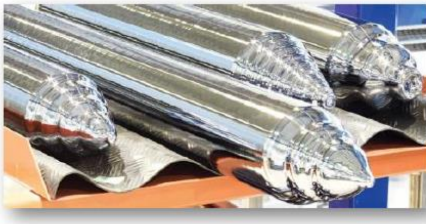
Figure III.5 : Présente des lingots de silicium monocristallin obtenus par la méthode Czochralski.
