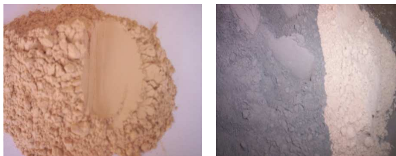
Figure 2.2 : Fillers et mélange Fillers en substitution au ciment
