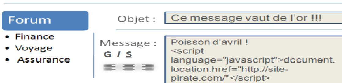
**Figure 3 : Exemple d'attaque de type XSS**
