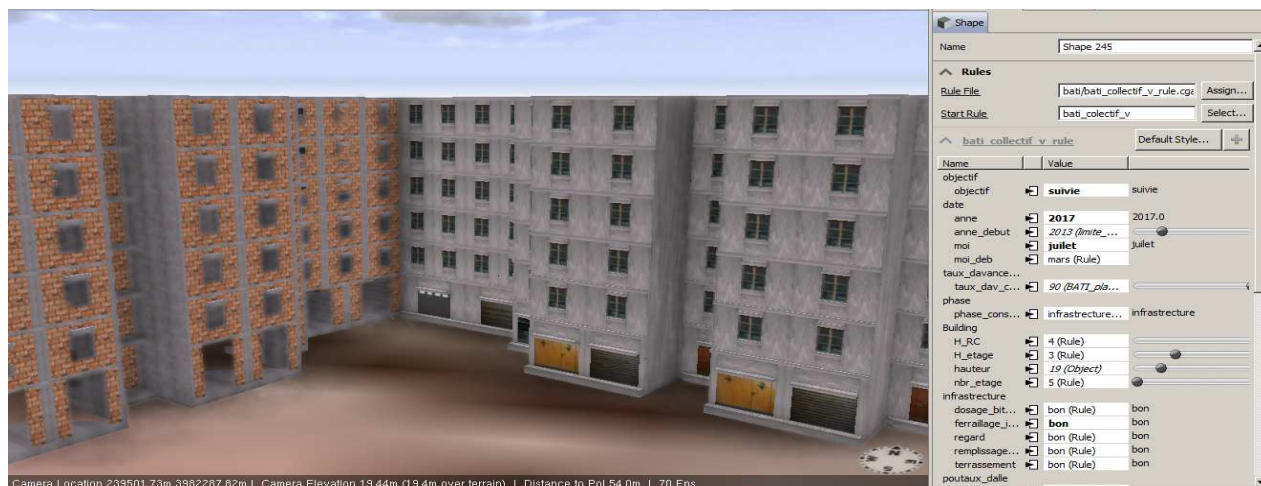
Figure 4.13 : Génération d'un modèle de bâti pour des fins de suivi lors de la phase enduit ciment
