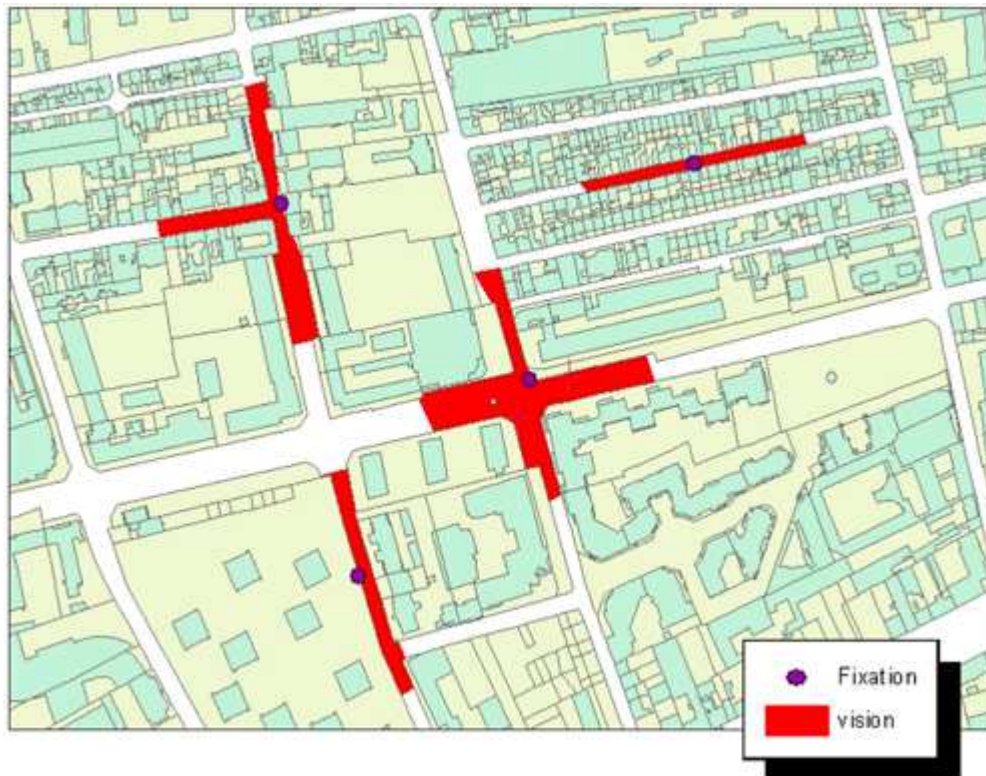
Figure 12 : Exemple de repérage des implantations de caméras avec champs de vision
