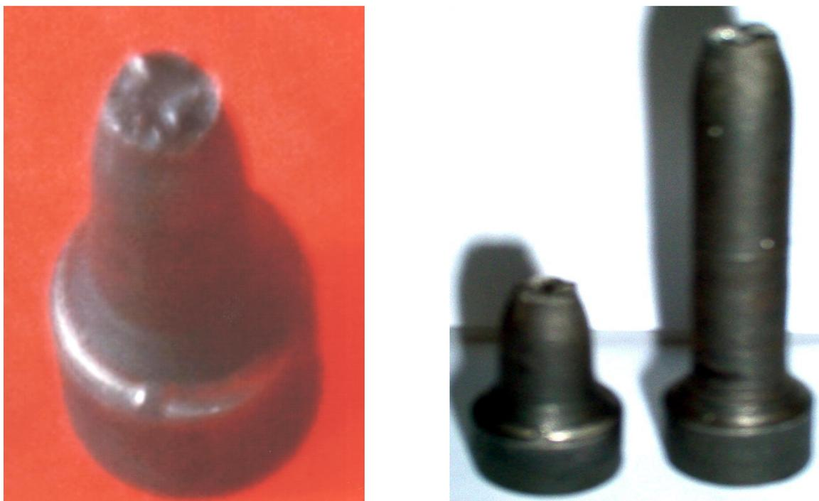
**Figure III.15** : macrographie montrant le faciès de rupture d'éprouvettes de traction, revenu à 400°C, 600°C
