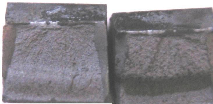
**Figure III.14** : macrographie montrant le faciès de rupture d'éprouvettes de résilience, revenu à 400°C
