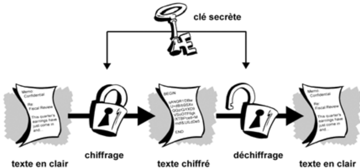
Fig. II.06. Schéma de principe d'un cryptosystème symétrique.
