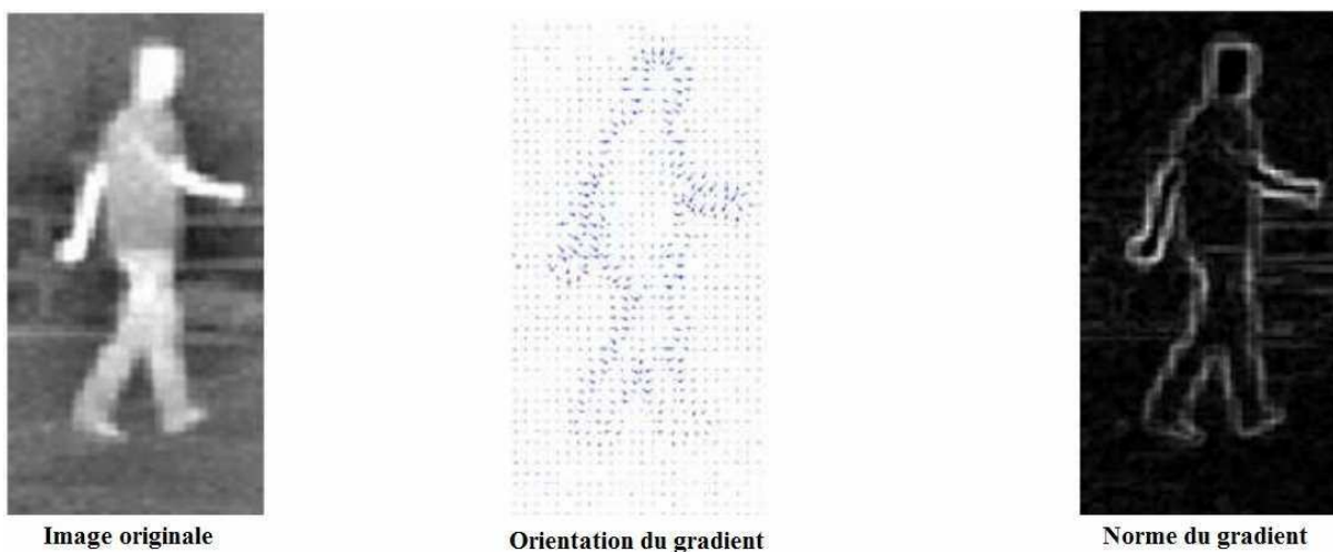
Figure 10 : Image d'un piéton avec une orientation et norme du gradient
