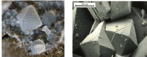
**Figure I.3 : La faujasite vue sous binoculaire et au microscope électronique**
