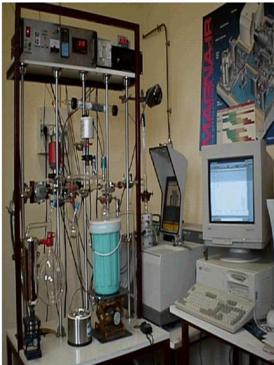
**Figure III.8-b: montage de FTIR « Thermo-Nicolet ».**
