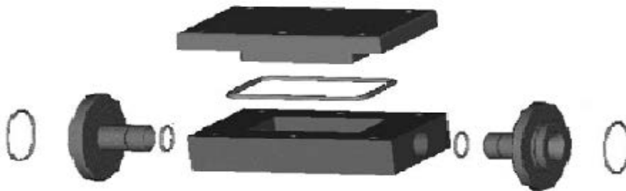
Figure II-6. Schéma de la cellule de mesure du potentiel d'écoulement tangential
