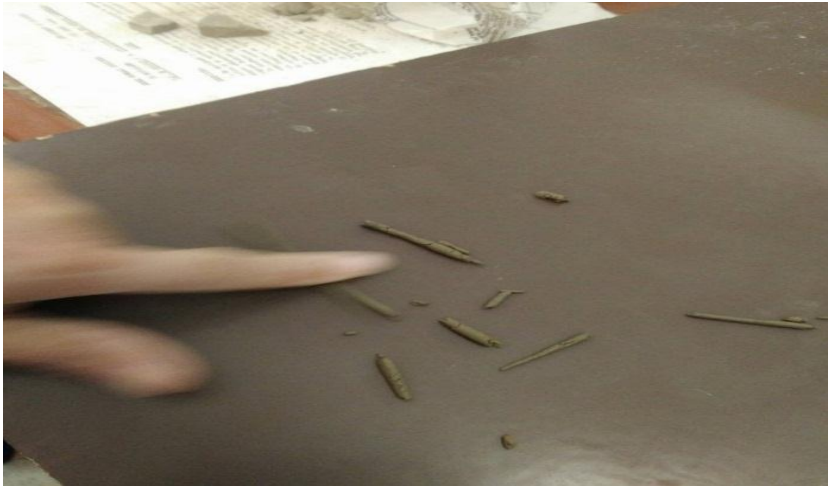
Figure(IV.16) :Fissuration du rouleau.
