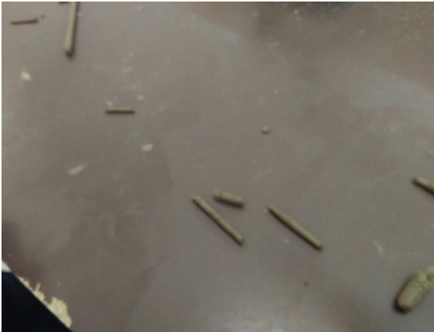
Figure(IV.15) : Confection du rouleau pour la détermination de la limite de plasticité.
