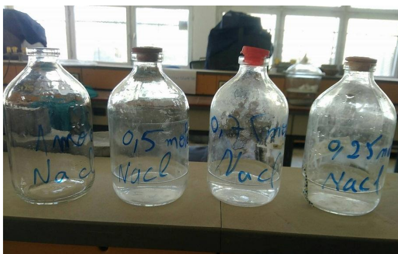
Figure(V.7) : Préparation des solutions salines de NaCl avec différentes concentrations
