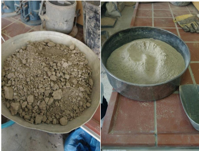
Figure(IV.4) : Echantillons d'argile avant et après broyage.
