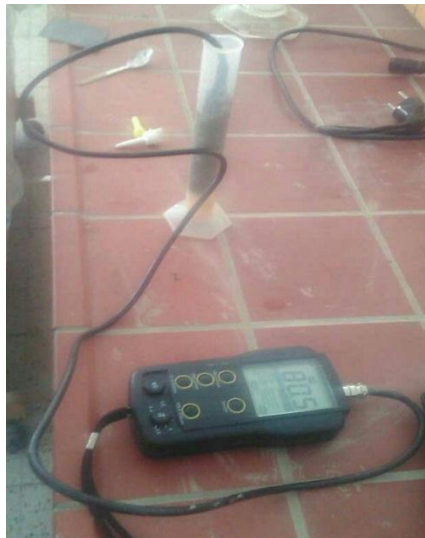
Figure (IV.5.) : La mesure de la conductivité électrique
