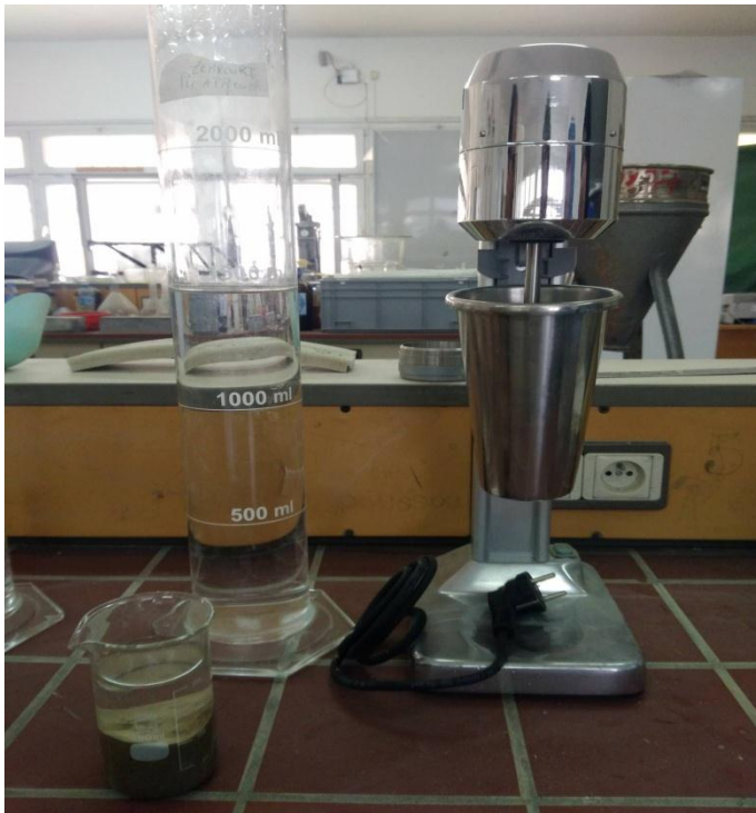
Figure (IV.9) : Essai de Sédimentation.
