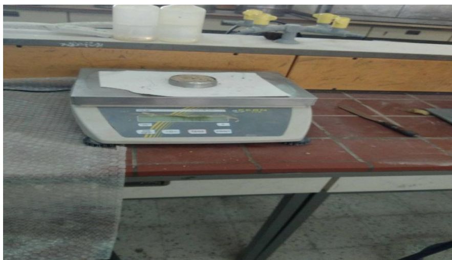
Figure (IV.7) : L'essai la masse volumique apparente
