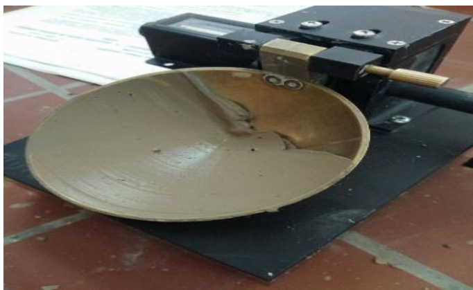
Figure (IV.13) : réalisation de la rainure.
