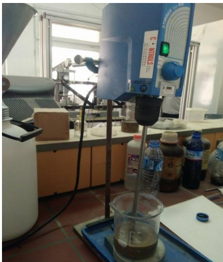
Figure (IV.18) : La réalisation de l'essai au bleu de méthylène
