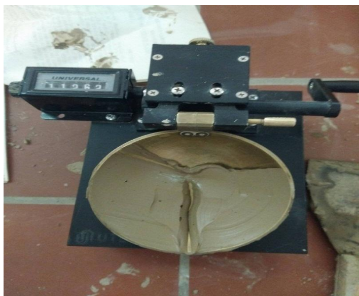
Figure (IV.14) : Fermeture de la rainure.
