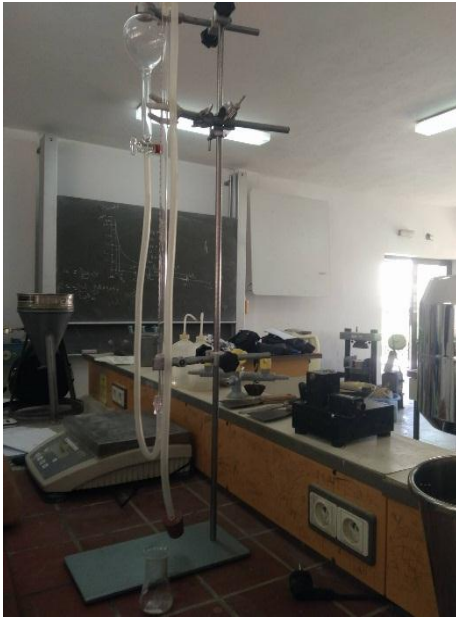
Figure(IV.20) : Dosage des carbonates
