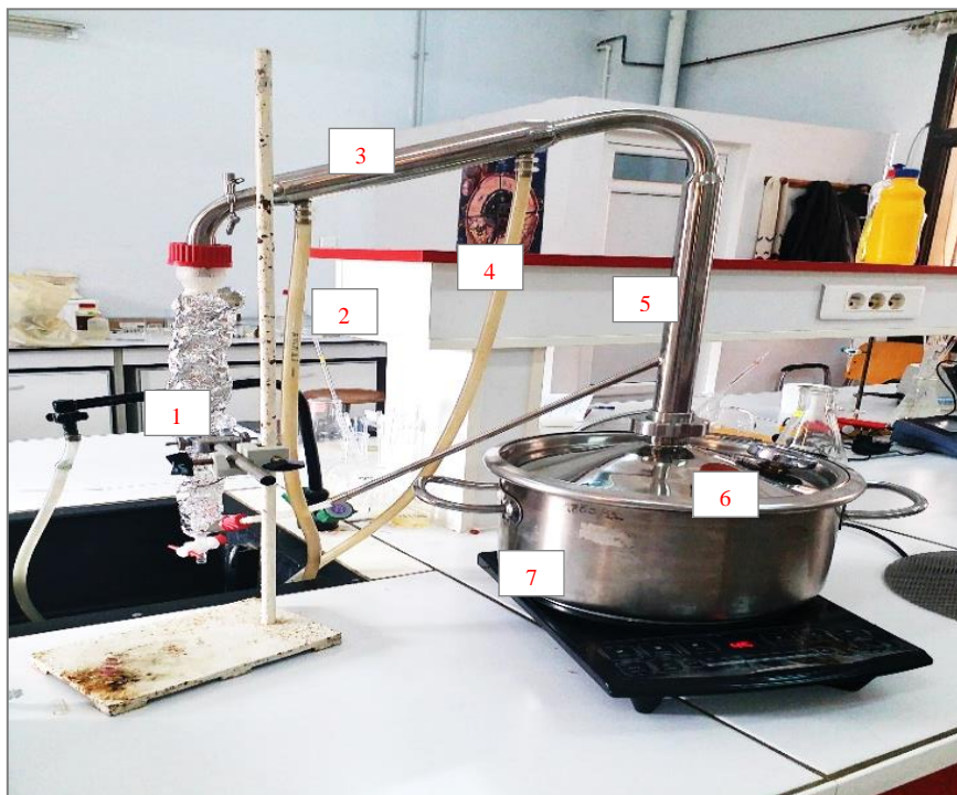
Figure 15 : L'entraînement à la vapeur d'eau (Original, 2020).
