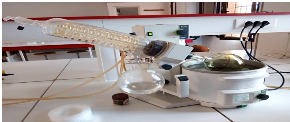
Figure12. Evaporation sous vide à 45°C
