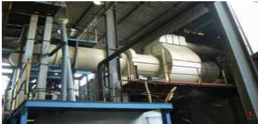
Figure (I.11) : le séchage du sucre blanc.
