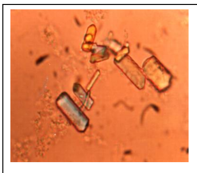
Photographie III.20 : Cristallisation sans inhibiteur, ( T_{moy}(str)=32,5\mu m ).
