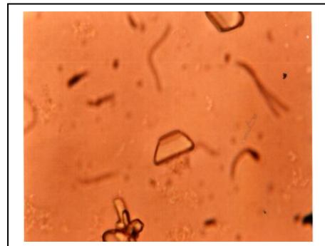
Photographie III.17 :Cristallisation phosphocalcique en présence des feuilles de figuier à C1 (Tmoy(str)=16,25µm).
