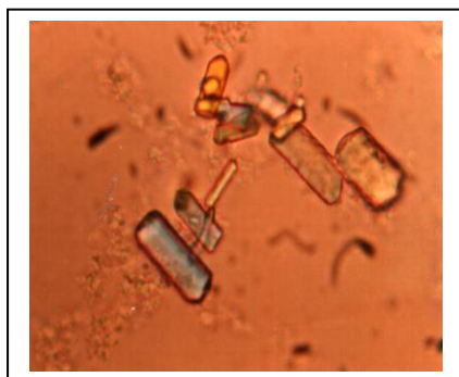
Photographie III.5 : Cristallisation phosphocalcique sans inhibiteur, T_{\text{moy}}(\text{str})=32,5\mu\text{m}
