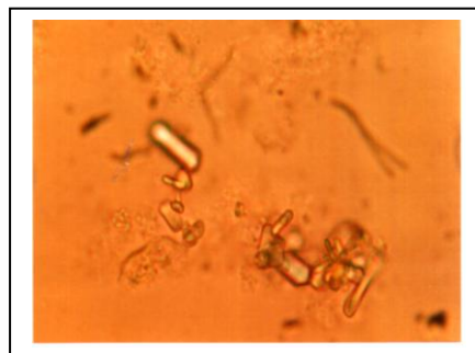
Photographie III.12 Cristallisation phosphocalcique en présence des styles de maïs à C3, ( T_{moy}(str) = 13,75\mu m ).
