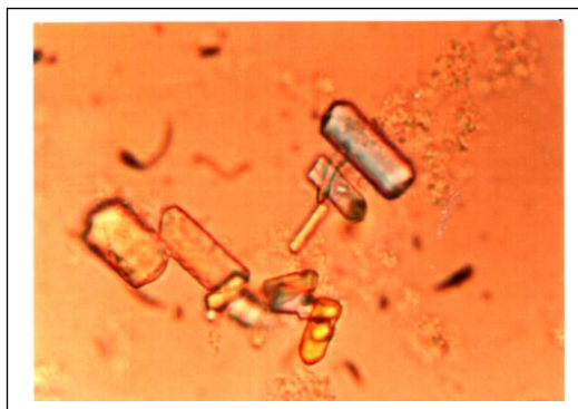
Photographie III.2 : Cristallisation phosphocalcique sans inhibiteur ( T_{moy} (str) = 27,5\mu m )
