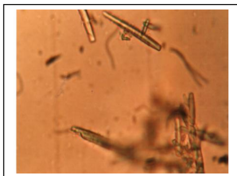
Photographie III.3 : Cristallisation phosphocalcique (sans inhibiteur) .,Tmoy(bru)= 28 \mu m
