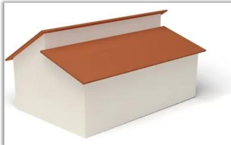
Figure 28: Toiture - Double pente ventilée asymétrique
