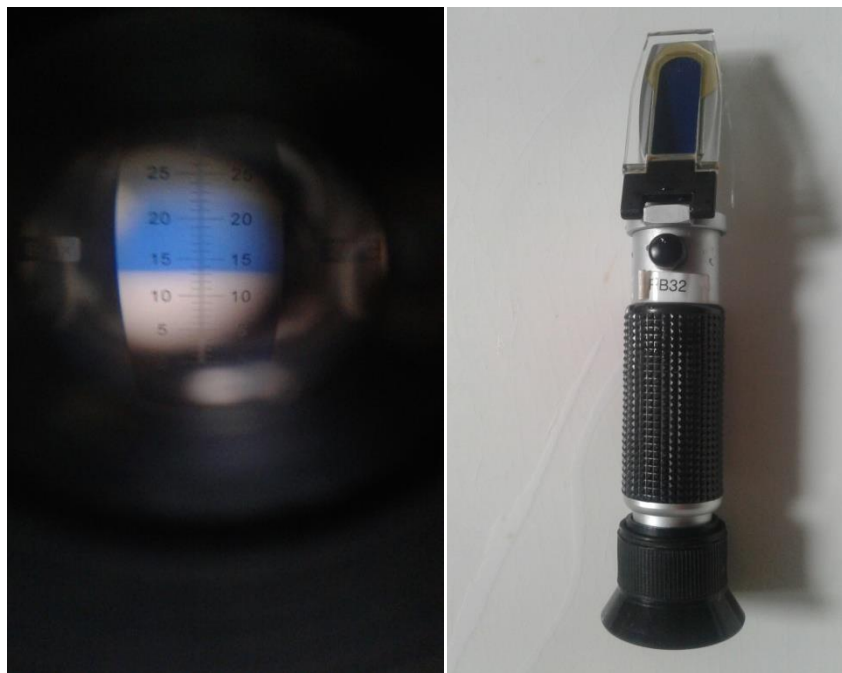
Figure 05 : lecture du brix dans le réfractomètre Figure 06 : réfractomètre
