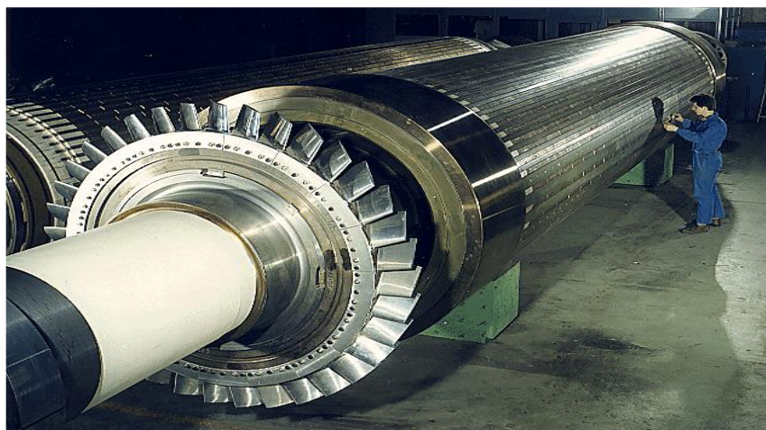
Figure (I-12) : Rotor à Pôles lisses d'un alternateur haut tension [1]
