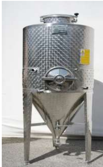
Figure 12 : Cuve de décantation en inox
