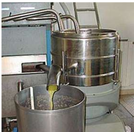
Figure 13 : Centrifugeuse. À droite sortie de l'huile d'olive, à gauche sortie des margines
