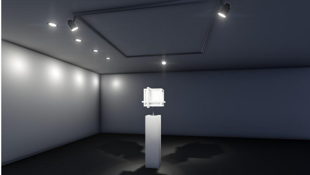
Figure 113: Eclairage sur trois côtés - mise en valeur d'un objet tridimensionnel (Par : Benriati Ferial).
