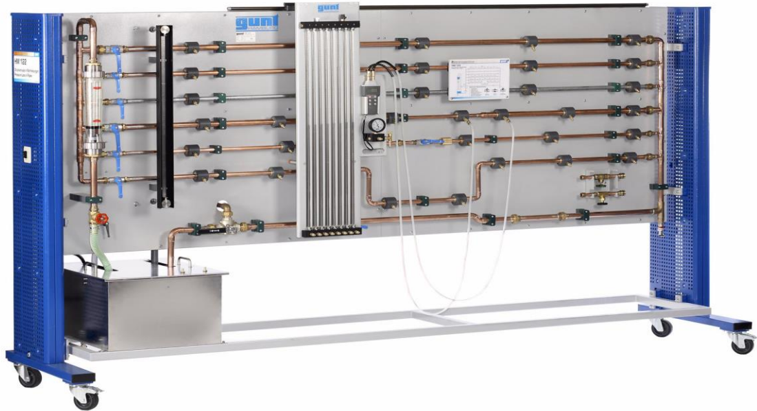
Figure III.1 : L'appareil HM122- banc d'essai perte d'écoulement-
