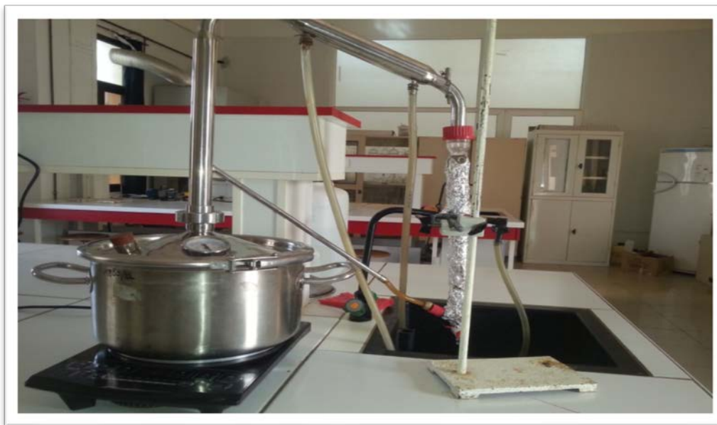
Figure n° 17: Vapodistillation de type SPRING A 105 12 LITRE utilisé pour l'extraction des huiles essentielles de deux plantes.
