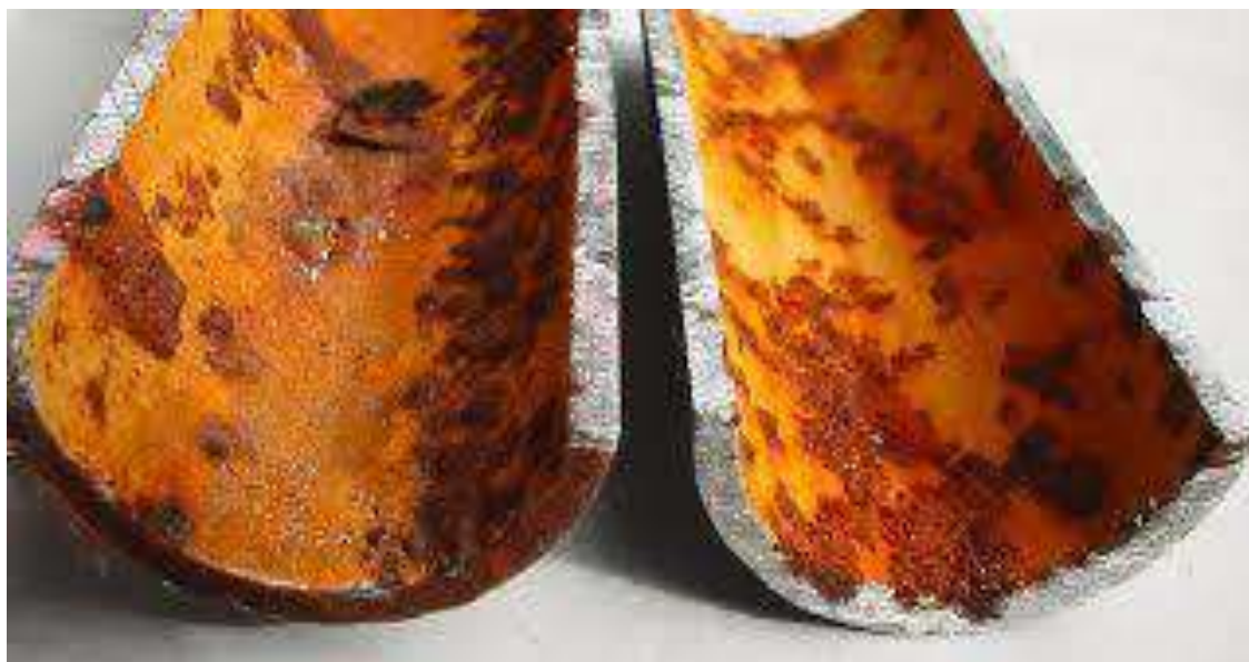
Figure I.3: Corrosion interne du métal.
