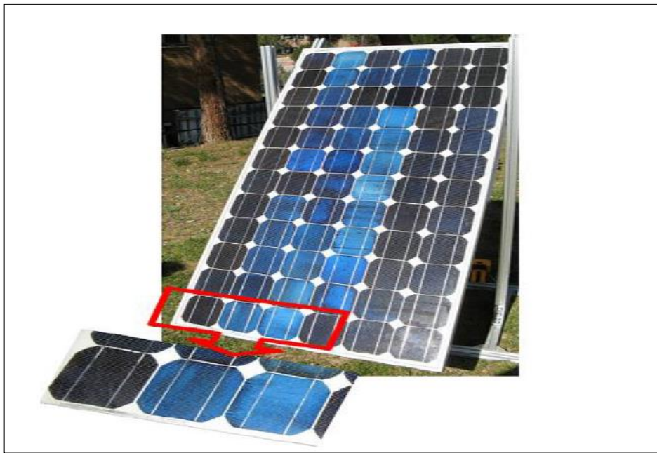
Figure II.7 : Défaut de revêtement anti –reflet
