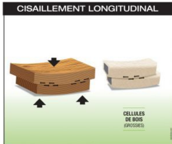
Figure 23: La résistance en cisaillement d'une pièce de bois, source ( site web cecobois 2025)
