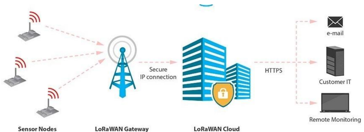
Figure 5: Architecture du réseau LoRa . [13]
