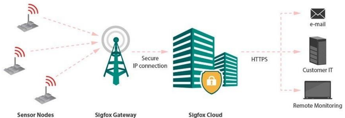
Figure 6: Architecture du réseau Sigfox [13]
