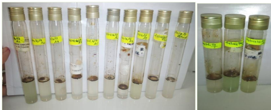
Figure n°17 : Test de biodégradation du pétrole sur milieu MSM liquide.
