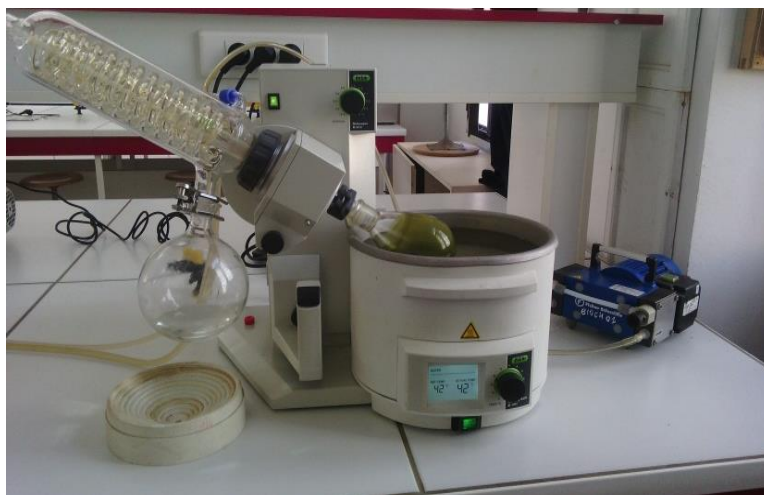
Figure n° 6 : l'évaporateur rotatif (Type : BUCHE R-210).
