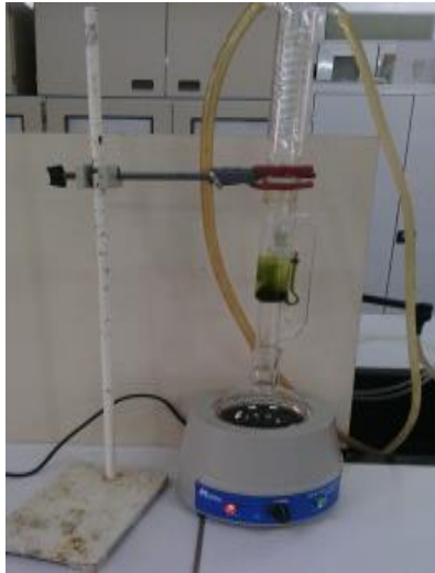
Figure n° 5 : le montage de l'extraction soxhlet.
