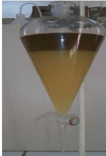
Figure n° 8 : Extraction des flavonoïdes par butanol.
