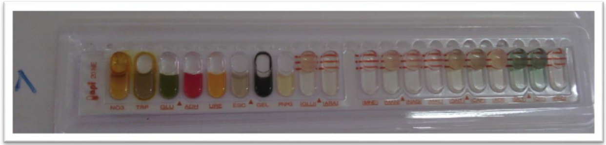
Figure n° 18: Résultats de l'API 20 NE de l'isolat n°1 P. aeruginosa
