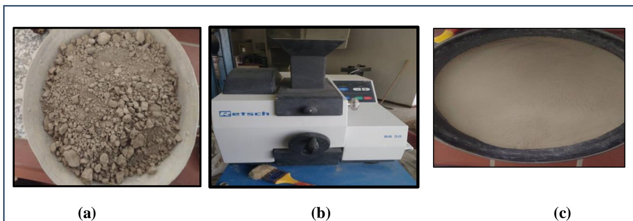
Figure (III.2) : Processus de préparation du sol : (a) concassage, (b) broyage,(c) tamisage
