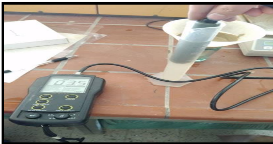
Figure (III.10) Essai de la conductivité de sol
