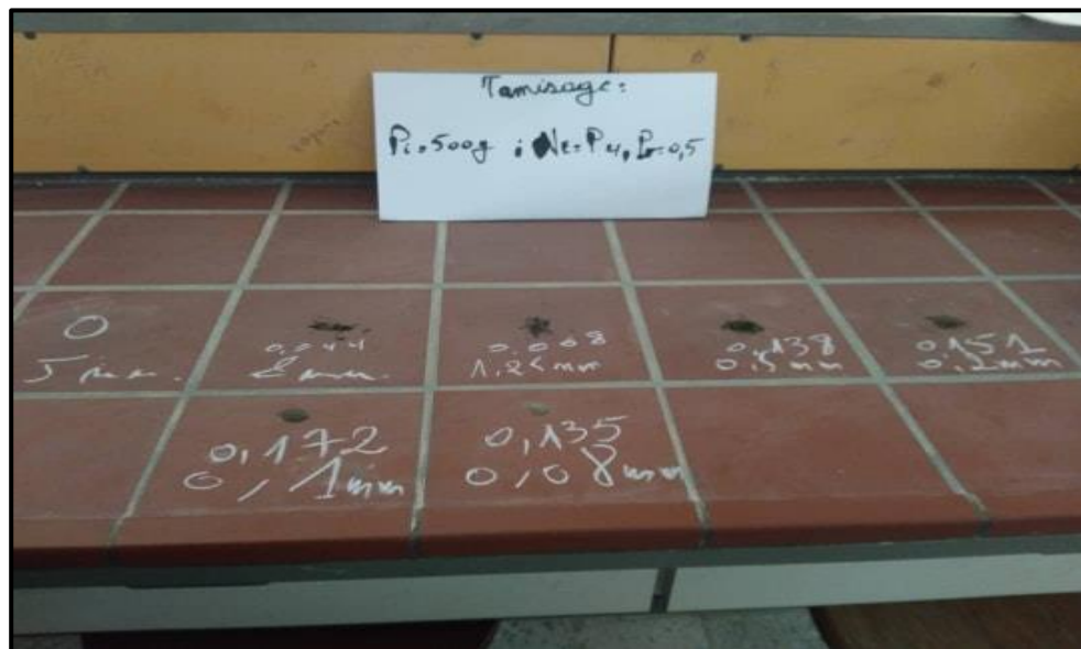
Figure (III.4) : Essai granulométrique du sol (fraction granulaire > 80\ \mu\text{m} .)
