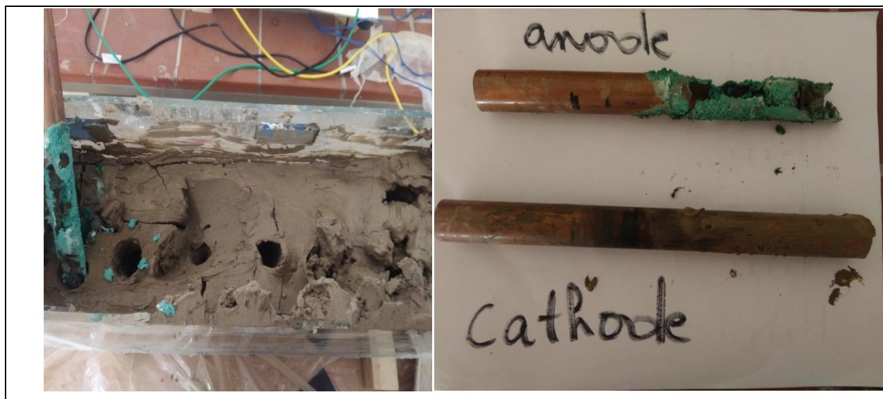
Figure (IV.8) : corrosion de l'électrode à la fin d'essai
