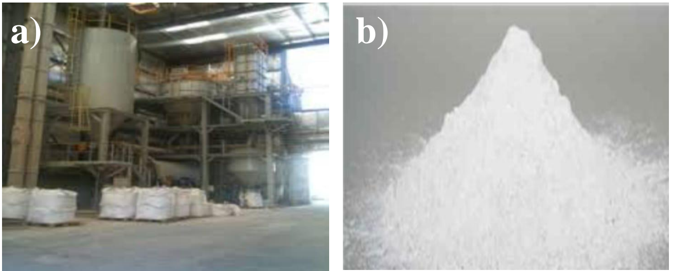
Figure I.6 :(a)Tamisage et stockage de la farine de silice, (b) La farine de silice
