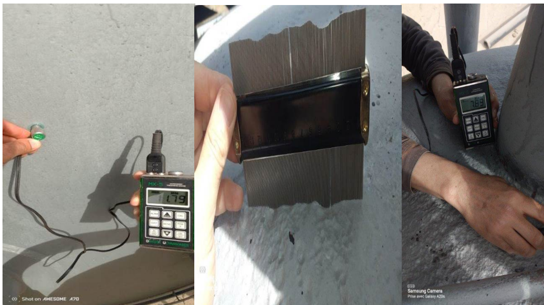
Figure IV.9: inspection par ultrason et visuellement
