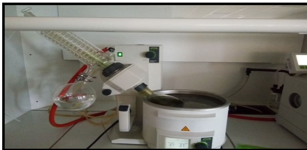
Figure 10. Etape d'évaporation sous-vide et de récupération d'extrait de Rosmarinus officinalis L
