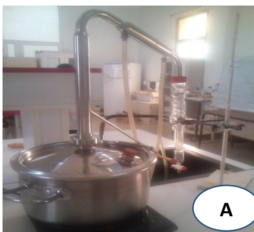
Figure N°18 : Hydro distillateur de type entraînement à la vapeur d'eau pour l'extraction de l'huile essentielle.
