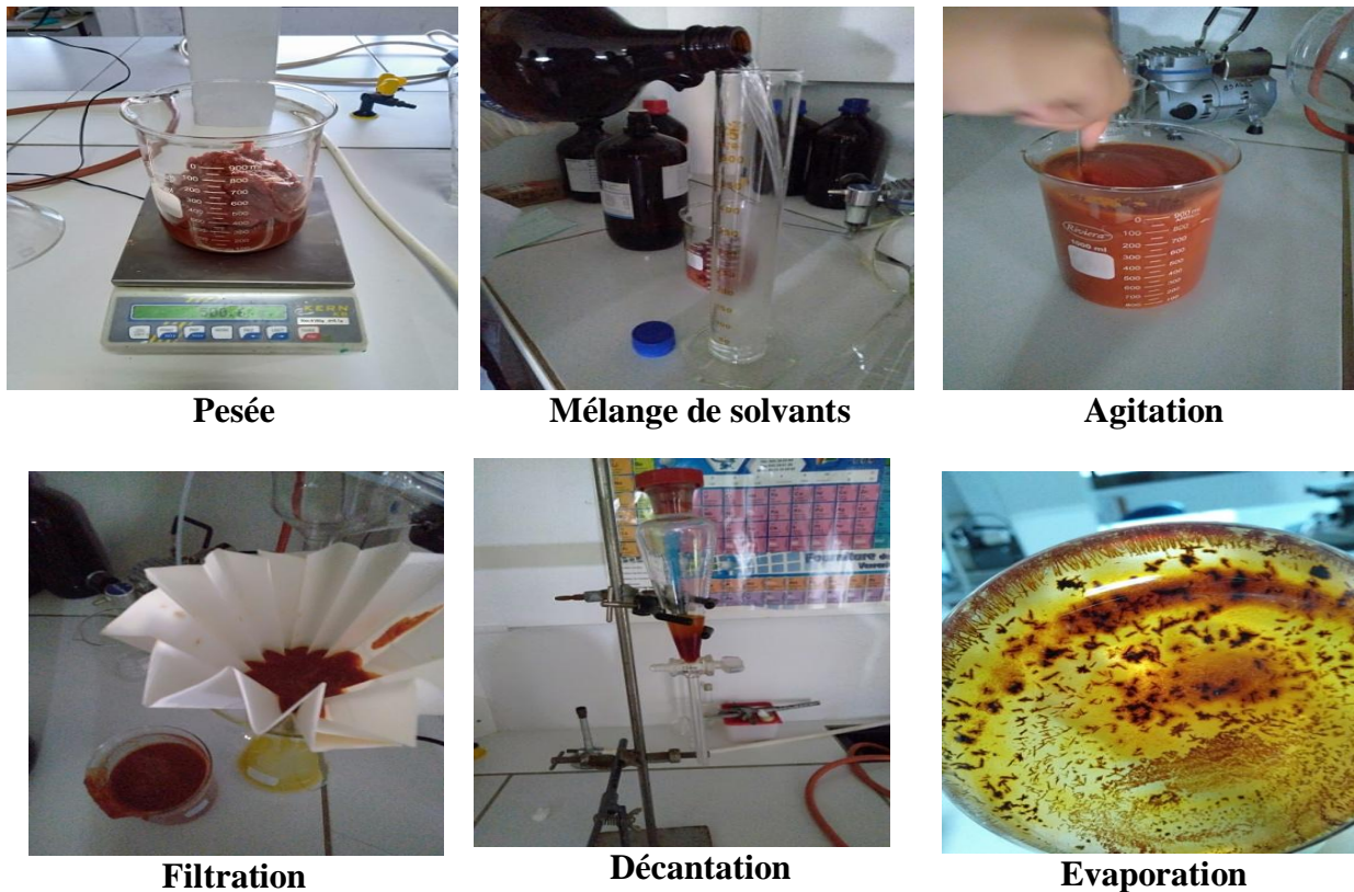
Figure 3: Les étapes de l'extraction de lycopène
