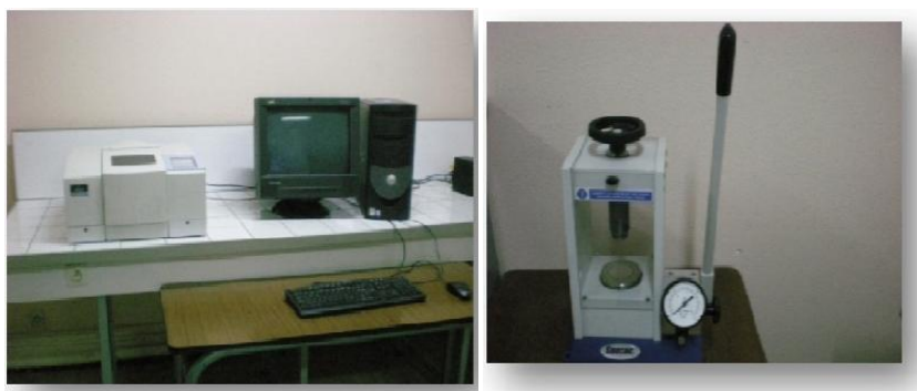
Figure N°22: (a) Appareil de l'infrarouge, (b) Pastilleuse
