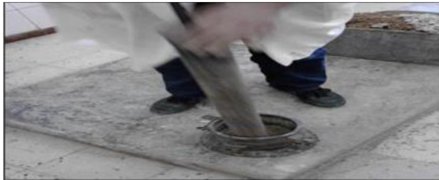
Figure n°45 : Matériels d'essai CBR.
