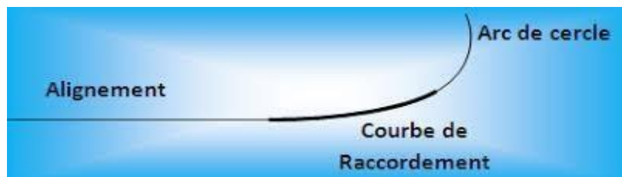
Figure n°09 : Élément du tracé en plan.
