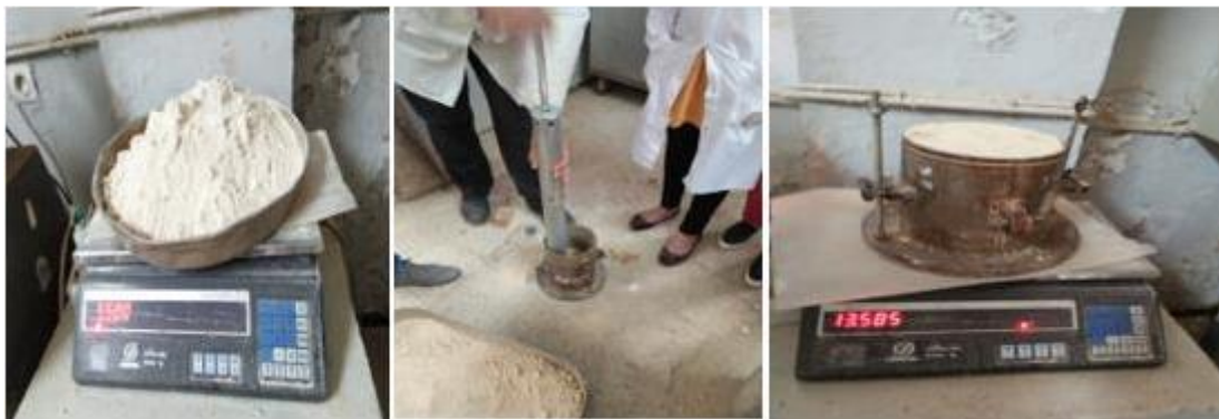
Figure n°44 : Les étapes de l'essai Proctor.
