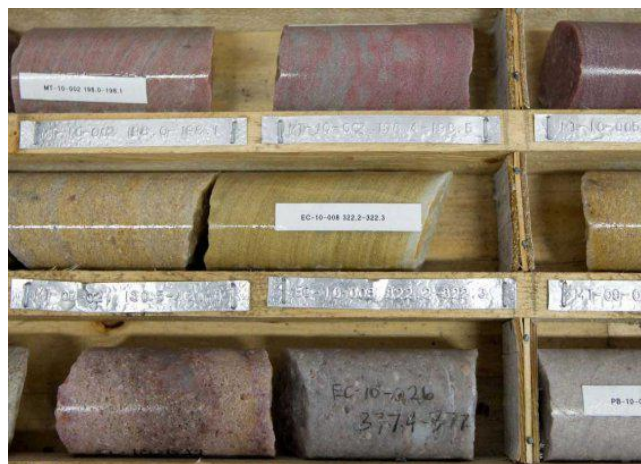
Figure n°48 : Exemple d'un essai de carottage.
