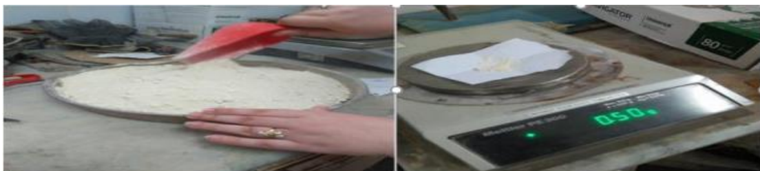
Figure n°39 : Tamisage de l'échantillon.
