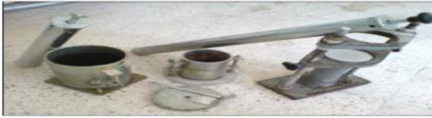
Figure n°43 : Matériels de l'essai Proctor.
