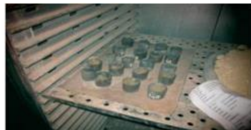
Figure n°28 : Matériels d'essai teneur en eau.
