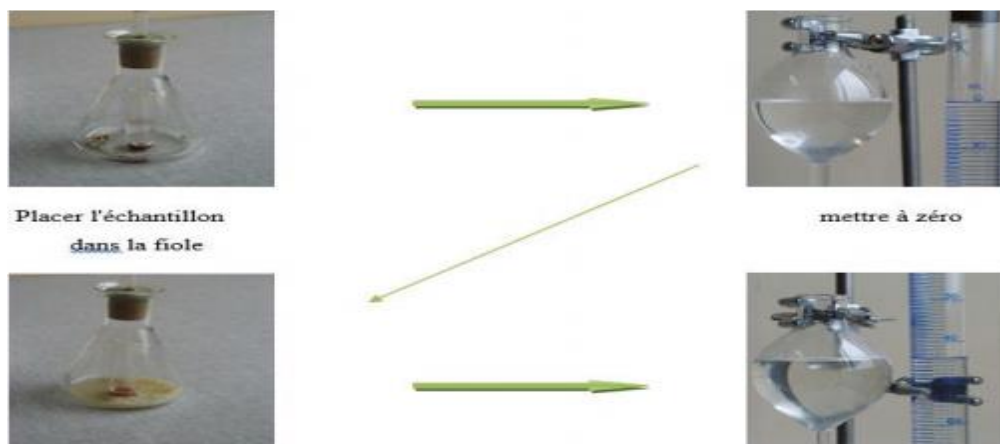
Figure n°41 : Mode opératoire de l'essai carbonate.
