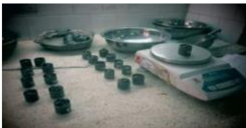
Figure n°28 : Matériels d'essai teneur en eau.
