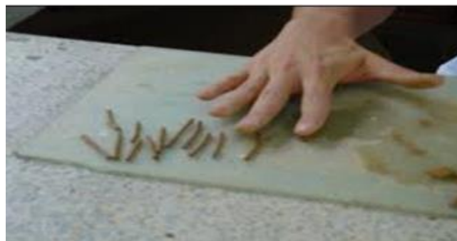
Figure n°37 : Limite de plasticité.
