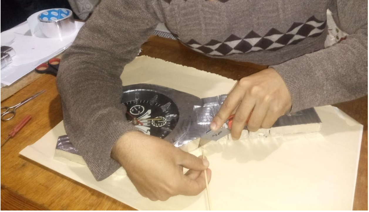
الشكل 10: تركيب السوار مع الهيكل
