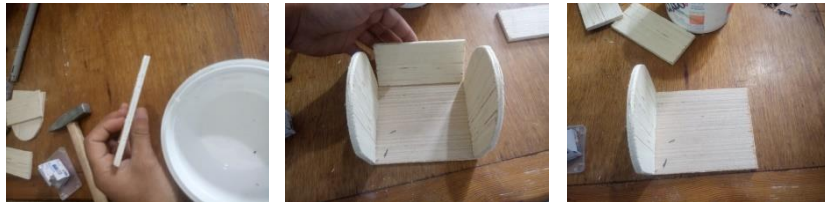
الشكل 72: عملية تركيب الأجزاء بالغراء المخصص للخشب .
