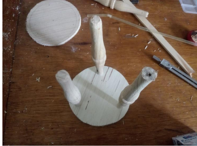
الشكل 19: تثبيت الأعمدة بغراء الخشب
