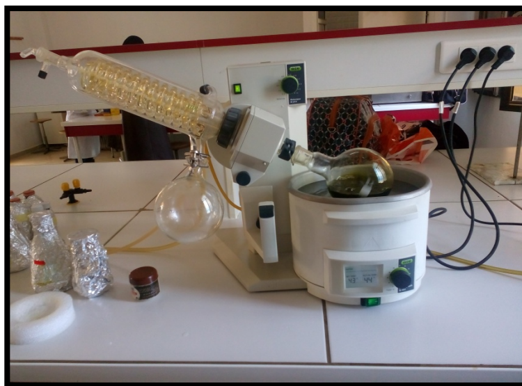
Figure 06. Etape d'évaporation sous vide de récupération des extraits de Thymus vulgaris .
