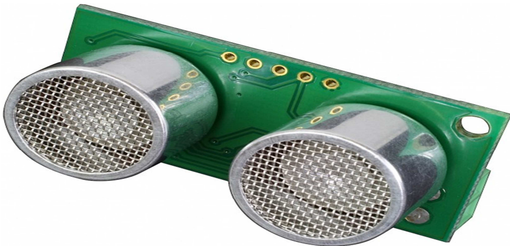
Figure II-2-b : Capteur ultrason type SRF06 vue en face.
