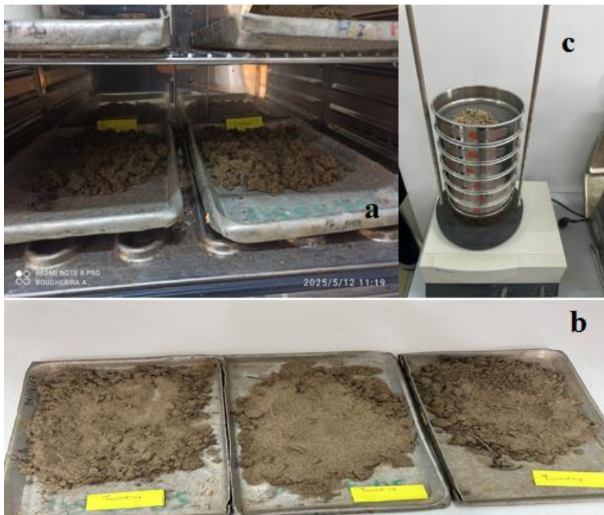
Figure 13: Les étapes de l'analyse granulométrique (a) Séchage du sédiment, (b) Pesage de 150 g de sédiment, (c) Tamisage.
