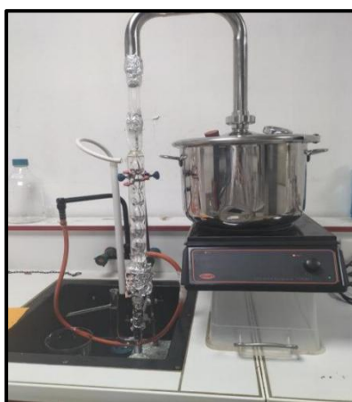
Figure 15: Extraction de l'HE L. nobilis par entraînement à la vapeur.
