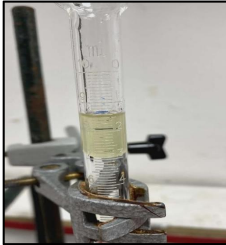
Figure 16 : Récupération de l'HE purifiée et détermination de son volume.
