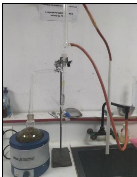
Figure 14: Extraction de l' HE T.vulgaris par hydrodistillation à l'aide d'un dispositif de type Clevenger.
