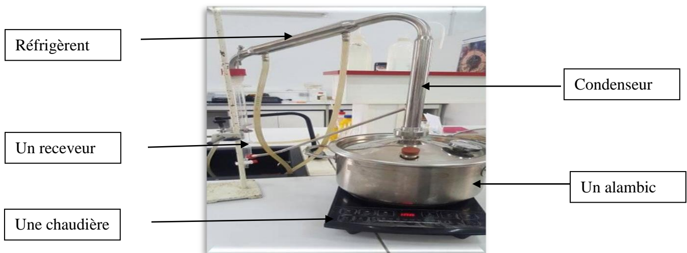
Figure 14 : Montage de l'extraction par entraînement à la vapeur d'eau (original, 2020)
