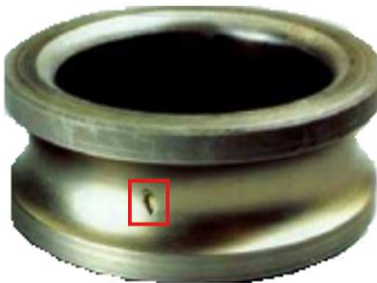
Figure I- 5: Écaillage initial de la sous-surface sur la bague intérieure [11].
