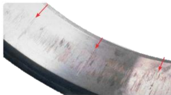
Figure I-8: Faux effet Brinell sur la piste de la bague extérieure d'un roulement [11].
