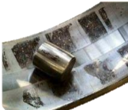
Figure I- 6 : Corrosion sur la surface de la bague extérieure [11].
