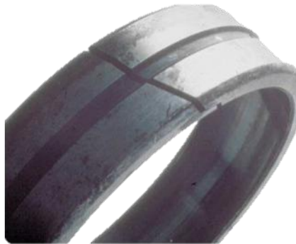
Figure I- 11: Rupture par fatigue d'une bague extérieure d'un roulement [11].
