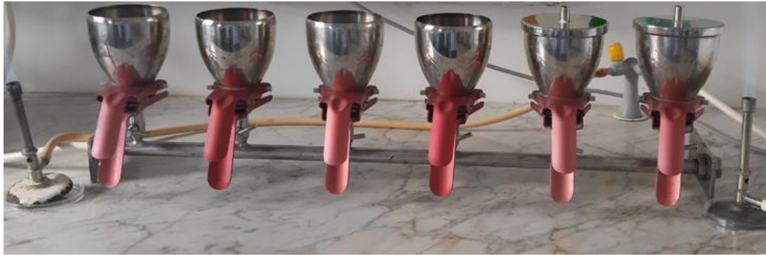
Fig.II.1 : Rampe à filtration dans la zone d'asepsie
