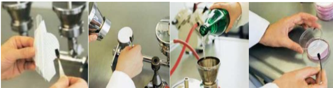
Fig.II.2 : les étapes de filtration par membrane
