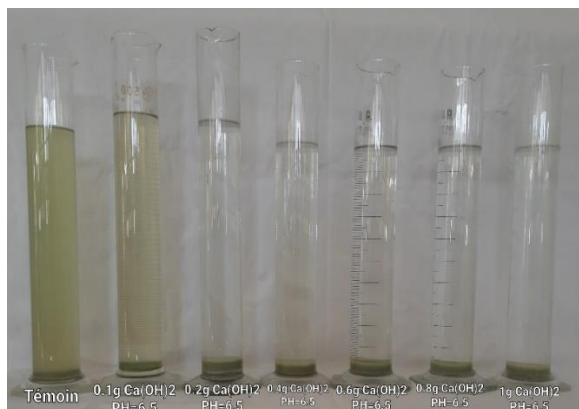
Figure.III.6 : Résultat visuel d'élimination de la turbidité et décantation des boues.
