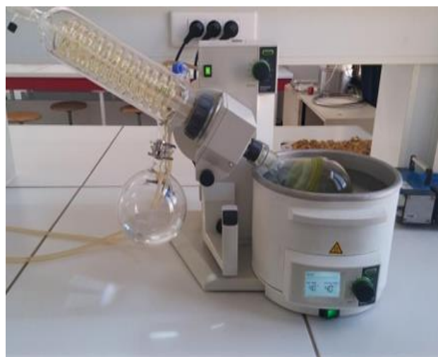
Figure 27 : Le dispositif du rotavapeur (Original, 2025)
