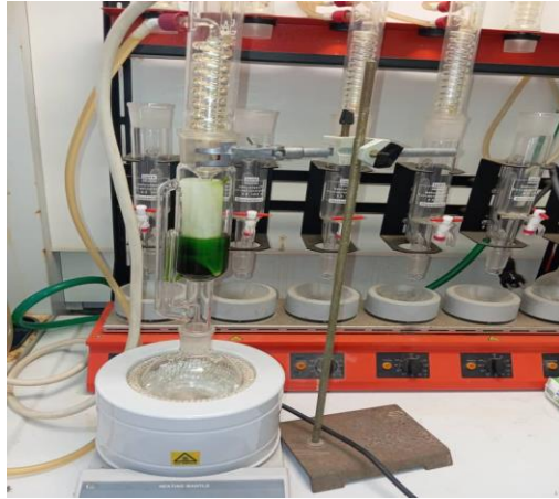
Figure 26 : Dispositif Soxhlet d'extraction par hydrodistillation
