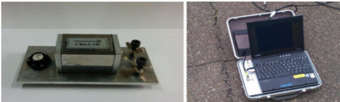
Fig.1.32. Équipement de mesure des vibrations ambiantes - capteur de vitesse et station d'acquisition
