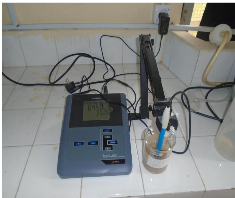
Photo N°04 : Mesure pH par le pH-mètre
