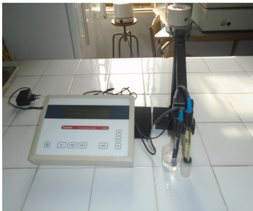
Photo N°05 : Mesure CE par conductimètre
