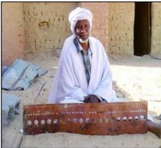
Photo : l'outil de La mesure de l'eau du foggara (chegfa) et l'expert de la mesure (kial elma)
