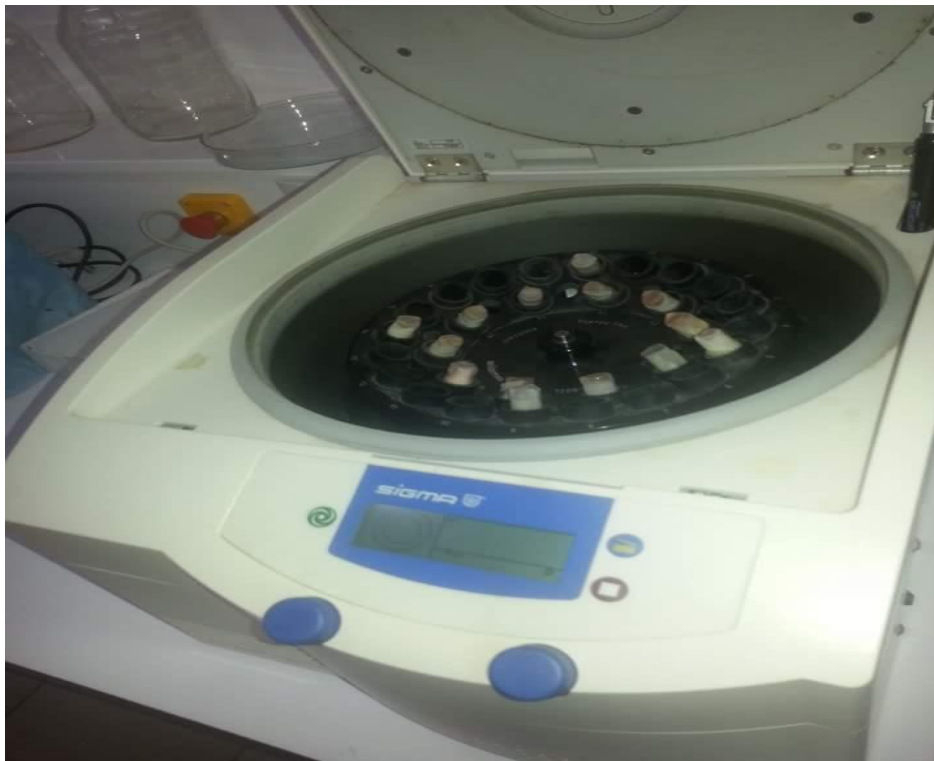
Photo N°08: Mesure l'humidité du sol par la centrifugeuse
